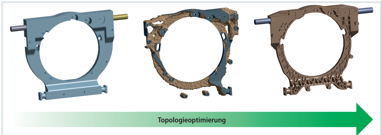
Bild 1. Bauraum, Ergebnis der Topologieoptimierung und kunststoffgerechte Konstruktion © Barlog Plastics
